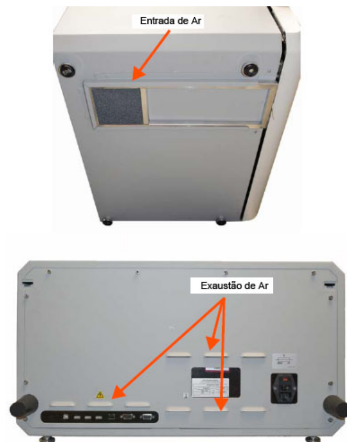
Figura 2-1 — Áreas de Entrada e Saída de Ar
